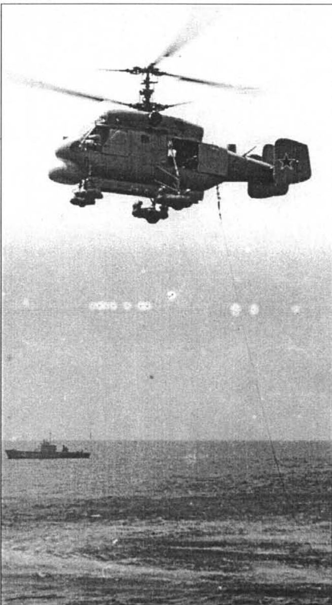
Выброс с "ДБШЗ" буксирного троса для приема шнурового заряда
