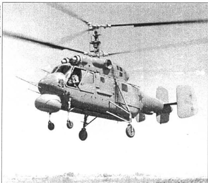
"ДБ" установочной серии со штангой-указателем скольжения (ДУАЗ) на испытаниях в Феодосийском филиале ОКБ
