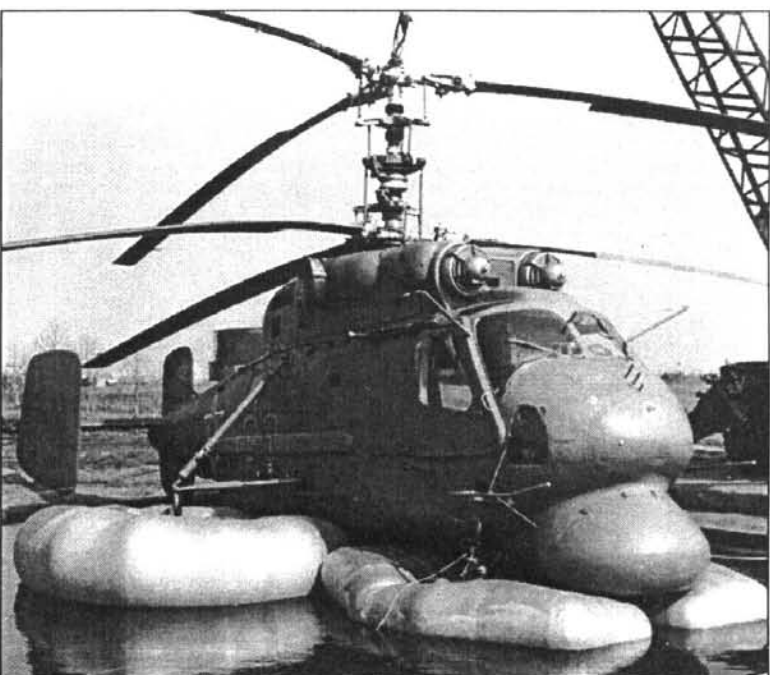
Во время испытаний балонетов
