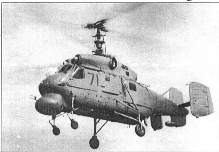
Один из первых серийных "ДБ" на испытаниях. Антенна СПАРУ-55 установлена на подфюзеляжном киле
