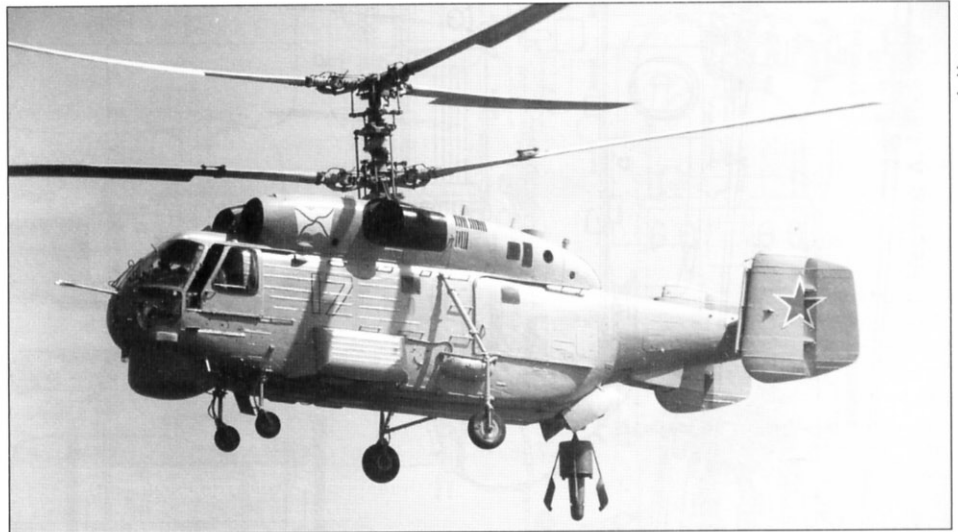
Ка-27ПЛ авиации ЧФ России в полете с выпущенной ВГС-3. Севастополь, 30 июля 2000 г.
