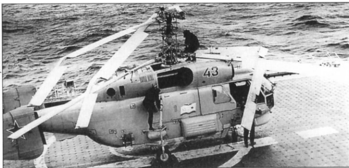
Результат схлестывания лопастей во время раскрутки винтов. ТАКР «Новороссийск», 26 сентября 1983 г.
