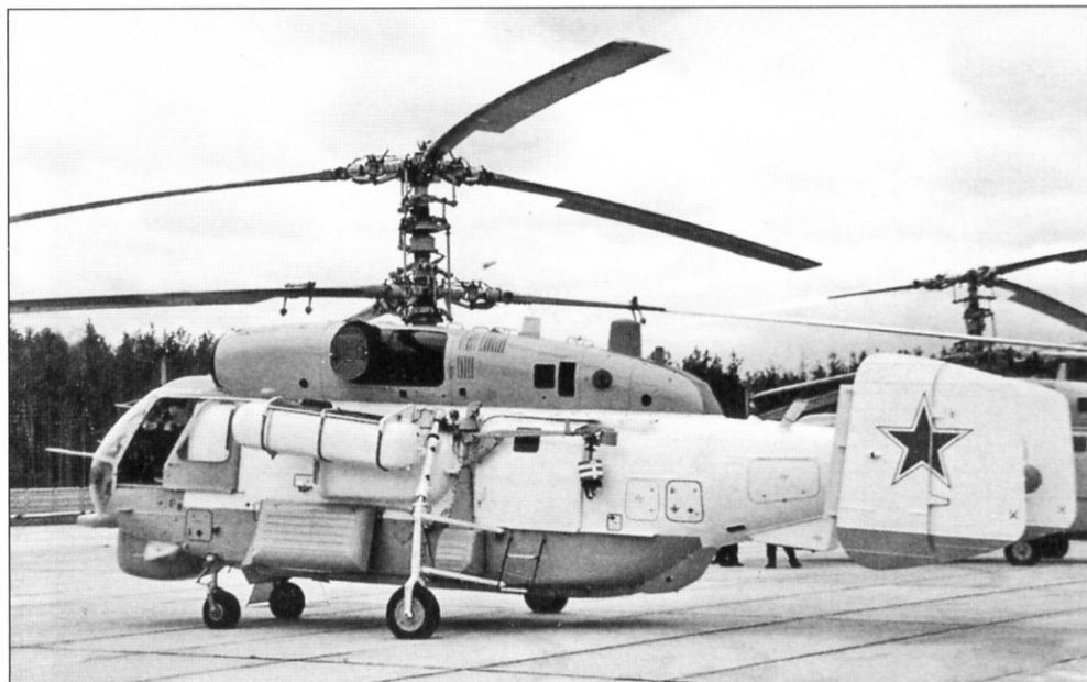
Опытный вертолет с увеличенной дальностью полета Ка-27ПСД Experimental Ka-27PSD helicopter with increased flight range
