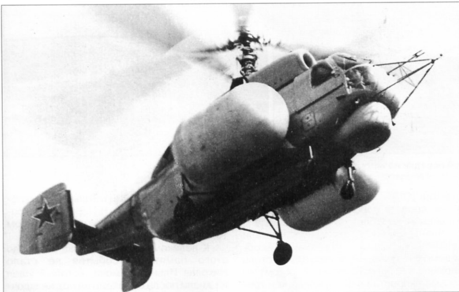
Второй опытный экземпляр Ка-252 в полете с выпущенными баллонетами The second Ka-252 prototype with extended balloons
