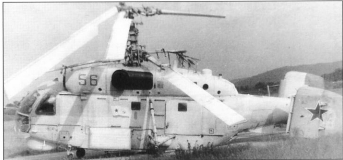
Этот Ка-27ПЛ из 289-го ОПЛАП также пострадал на земле от схлестывания лопастей. Новонежино, середина 1990-х гг.
