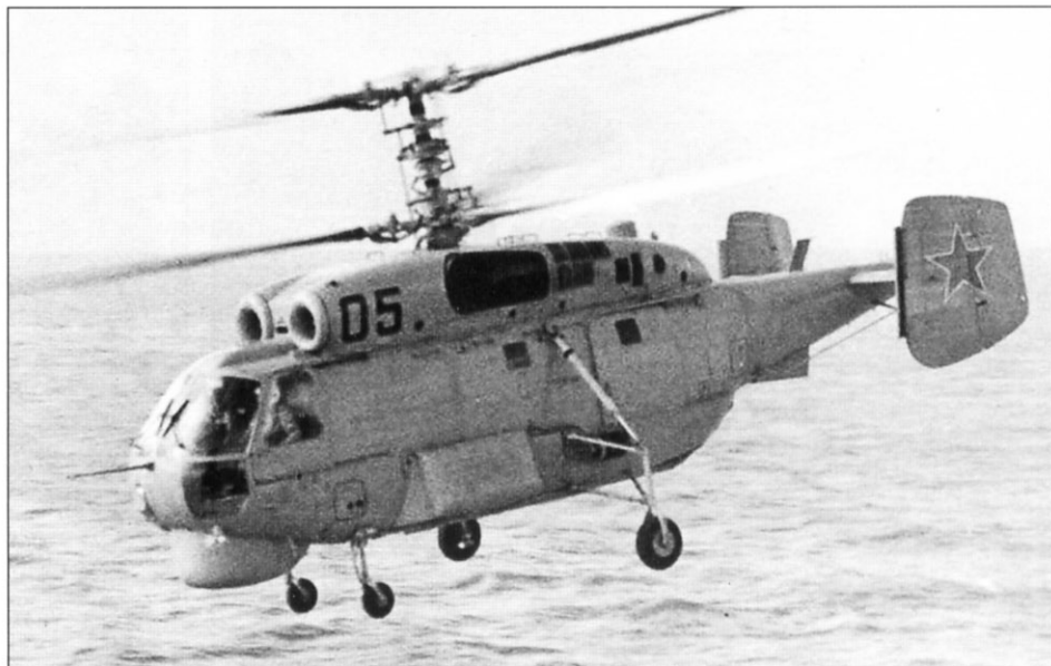
Первый предсерийный экземпляр Ка-252 во время Госиспытаний The first preserial Ka-252 is under state tests
