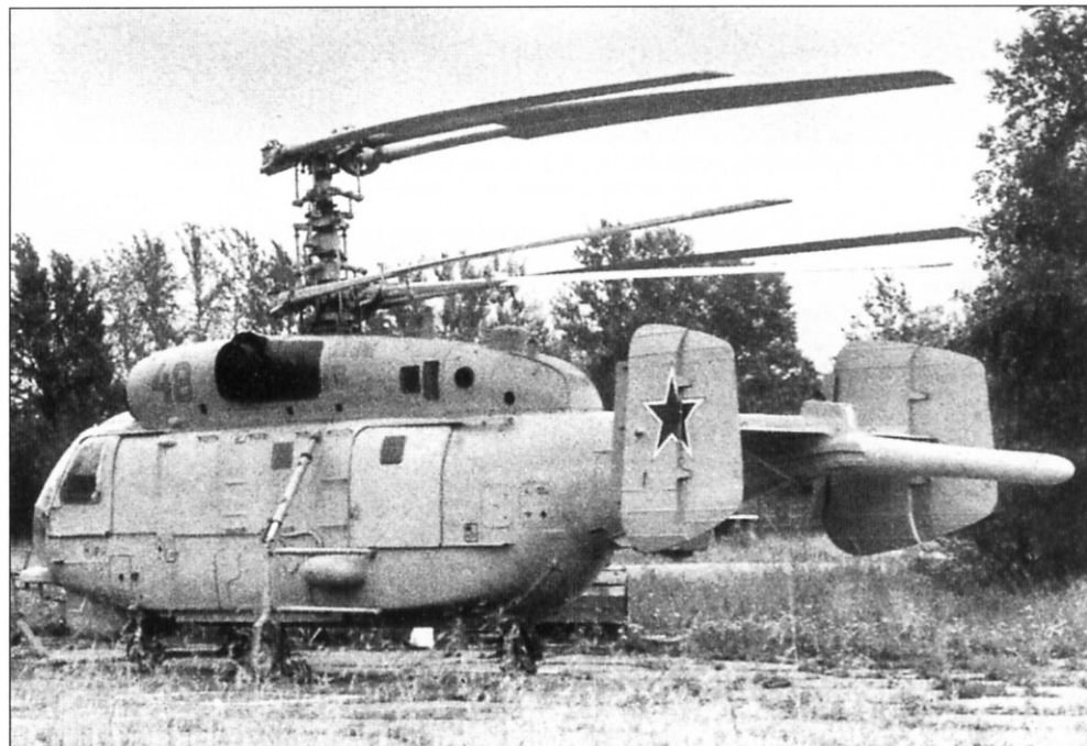
Летающая лаборатория Ка-27ЛЛ с установленным на хвостовой балке магнитометром The Ka-27LL flying laboratory with a magnetometer installed on the tail boom
