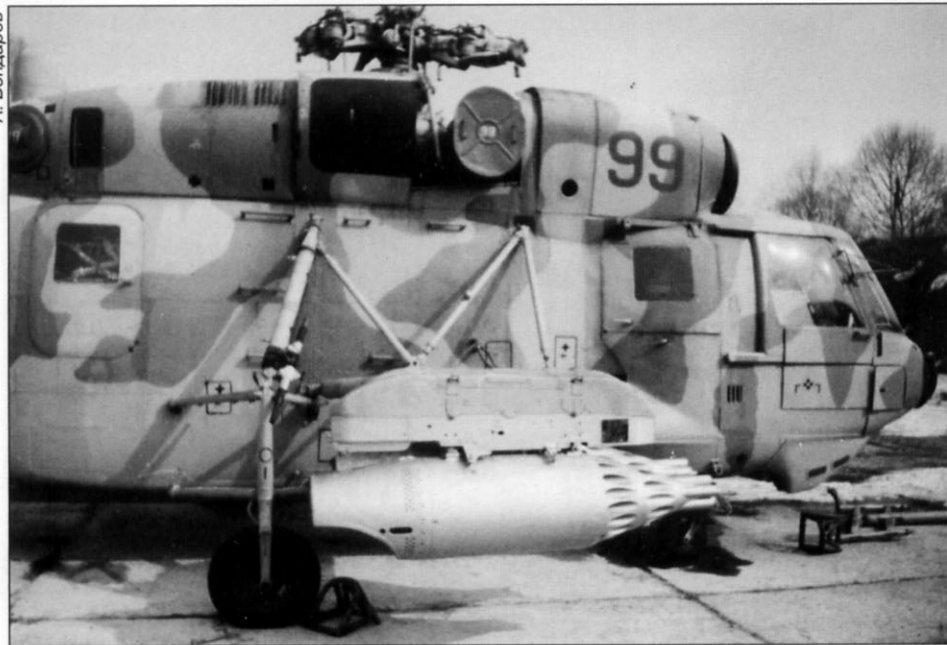
Подвеска блоков НАР УБ-32 на вертолете 710-го ОКПЛВП. Ферма подвески вооружения в сложенном положении Blocks of the УБ-32 unguided missiles are mounted of the 710th regiment. Pylon of the weapon is folded
