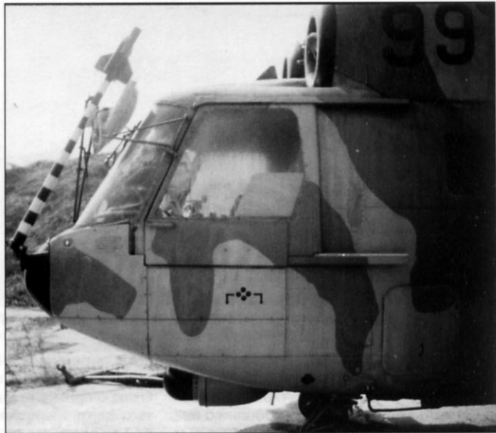
Правый и левый борта передней части фюзеляжа Ка-29. На бортах кабины экипажа видны бронеплиты Starboard and port side of front part of the Ka-29 fuselage. Armour plates are seen on the cockpit sides
