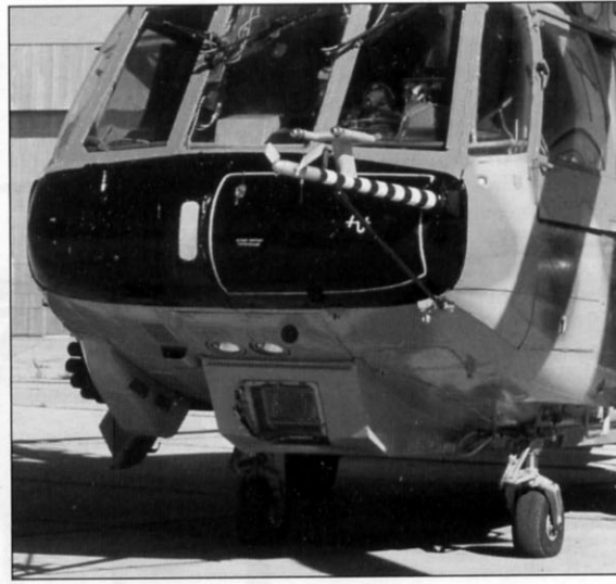
Снаряжение блока НАР Б8В20 ракетами. Справа — окно комплекса «Рубикон» на Ка-29ВПНЦУ Mounting the B8B20 unguided missiles. Right — window of the Rubicon complex on the Ka-29ВПНЦУ
