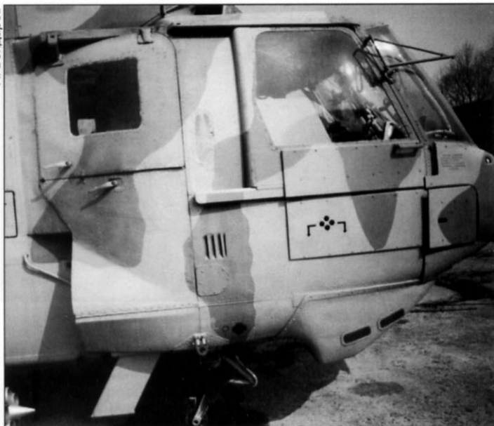
Правый и левый борта передней части фюзеляжа Ка-29. На бортах кабины экипажа видны бронеплиты Starboard and port side of front part of the Ka-29 fuselage. Armour plates are seen on the cockpit sides
