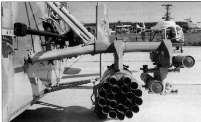
30-мм пушка 2А42, блок НАР Б8В20 и два контейнера ПТУР «Штурм» (слева). Пушковая для подвески ПТУР «Штурм» 2A42 30-mm gun, block of the B8B20 unguided missiles and two pods of the Shturm anti-tank missile
