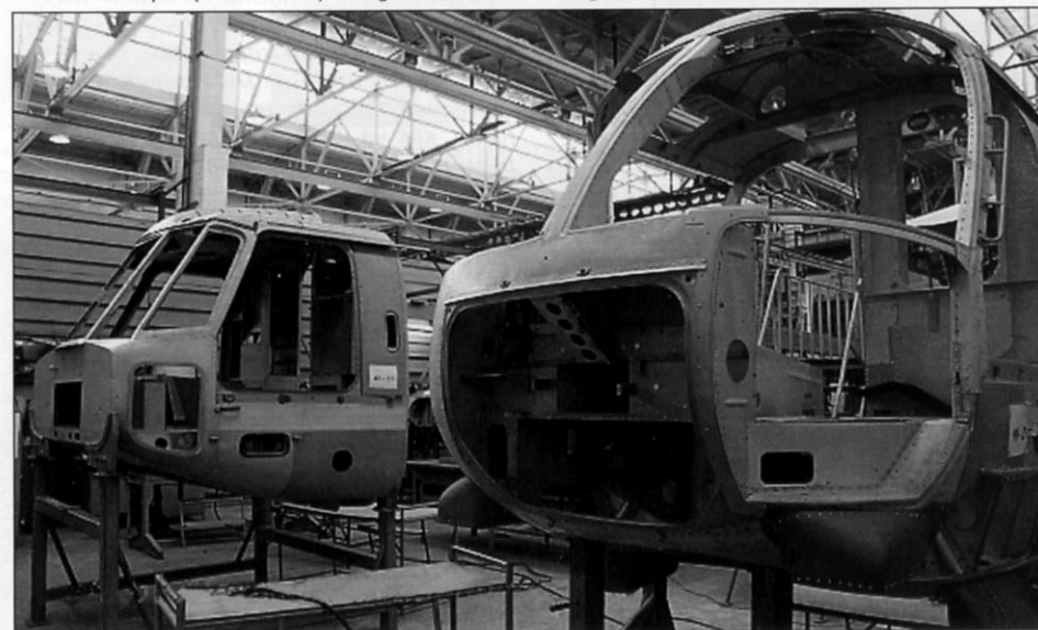
Кабины экипажей Ка-27 и Ка-29 (на заднем плане) в цехе агрегатной сборки Кумертауского АПП
