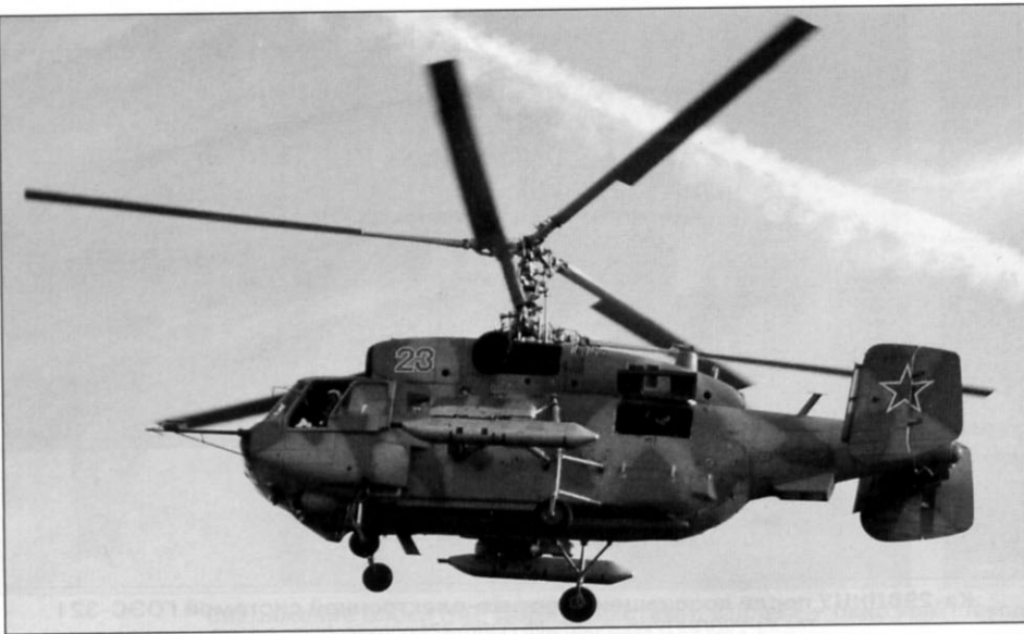
Ка-29, вооруженный двумя пушечными контейнерами УПК-23-250 The Ka-29 armed with two УПК-23-250 gun pods
