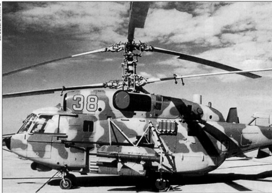
Ка-29 из 696-го ОИИВП, вооруженный в том числе ПТУР «Штурм» и пушкой 2А42 The Ka-29 of the 696th regiment armed with the Shturm anti-tank missile and 2A42 gun
