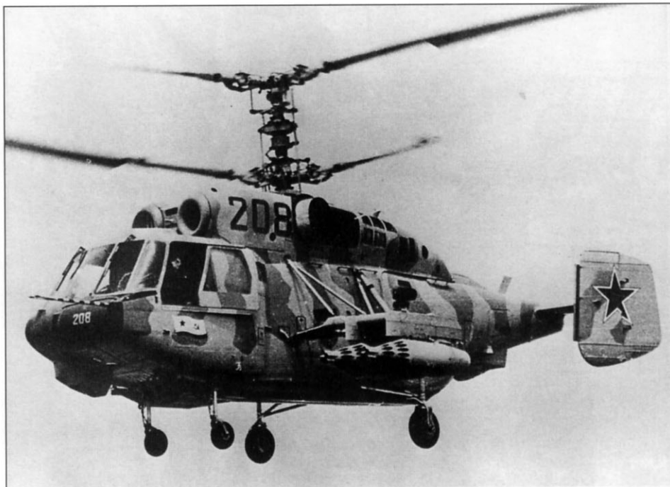
Первый прототип транспортно-боевого вертолета Ка-29 (изд. 02Д1) The first prototype of the Ka-29 (item 02D1) transport and attack helicopter
