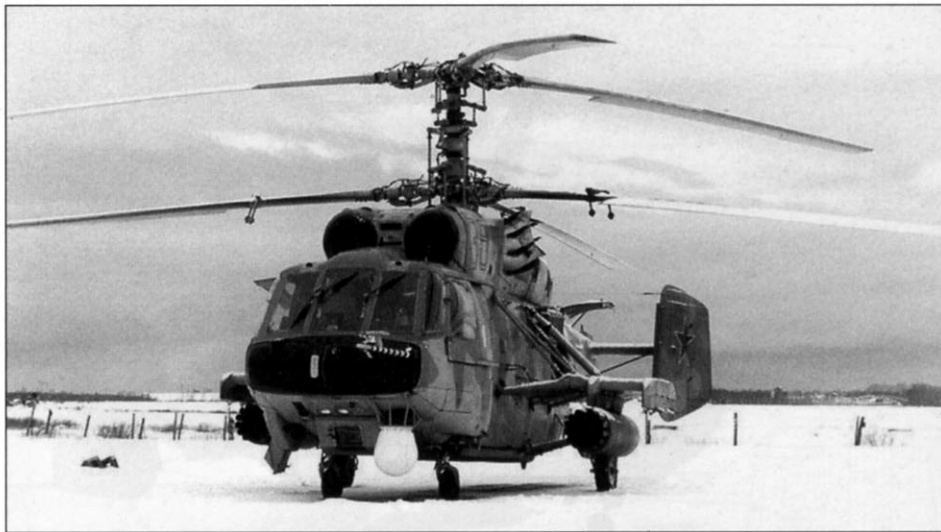
Ка-29ВПНЦУ после дооснащения оптико-электронной системой ГОЭС-321 The Ka-29VPL equipped with ГОЭС-321 optoelectronic system
