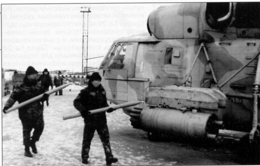
Снаряжение блока НАР Б8В20 ракетами. Справа — окно комплекса «Рубикон» на Ка-29ВПНЦУ Mounting the B8B20 unguided missiles. Right — window of the Rubicon complex on the Ka-29ВПНЦУ
