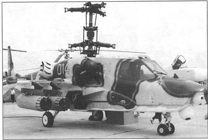
Четвертый летный экземпляр Ка-50 с двумя ГОЭС The fourth Ka-50 flight prototype equipped with two gyro-stabilized optoelectronic systems
