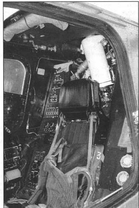
Ракетно-парашютная система К-37-800 K-37-800 unique ejection system
