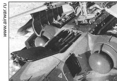
Капоты и люки открыты во время обслуживания вертолета Cowls and hatches are open during the helicopter maintenance
