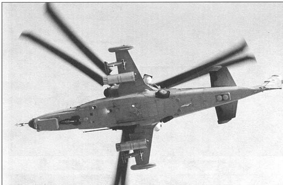
Внешний облик Ка-50 отличает «самолетный» фюзеляж Outward form of Ka-50 differs with an airplane-type fuselage
