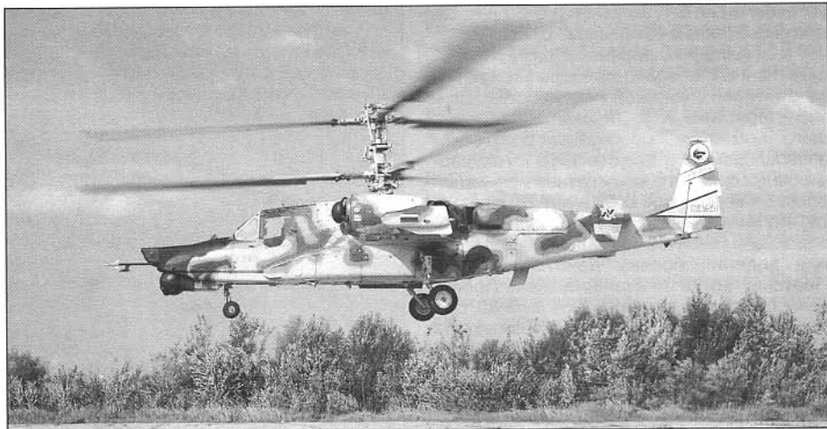
Ка-50Ш после доработки. Наддулоочная антенна РЛС не установлена Developed Ka-50Ш. The radar antenna over main rotor hub is not installed
