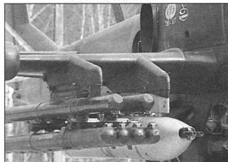
На внутреннем пилоне — пушечный контейнер УПК-23-250 УПК-23-250 gun pod on the inner pylon
