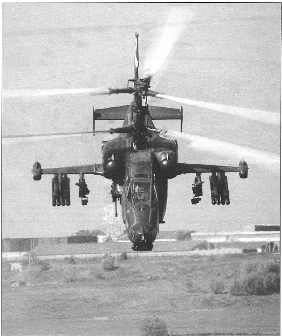
Во время испытательного полета по изучению динамики движения законцовок лопастей несущих винтов на предельных режимах. На внутренних пилонах — по три кинокамеры, фиксирующие положение законцовок
