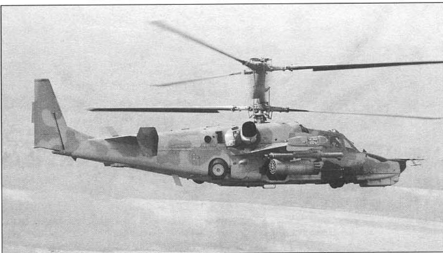
Ка-50 несет на внешних пилонах ракеты ПЗРК «Игла» Ka-50 carries «Igla» anti-aircraft missiles on the outboard pylons
