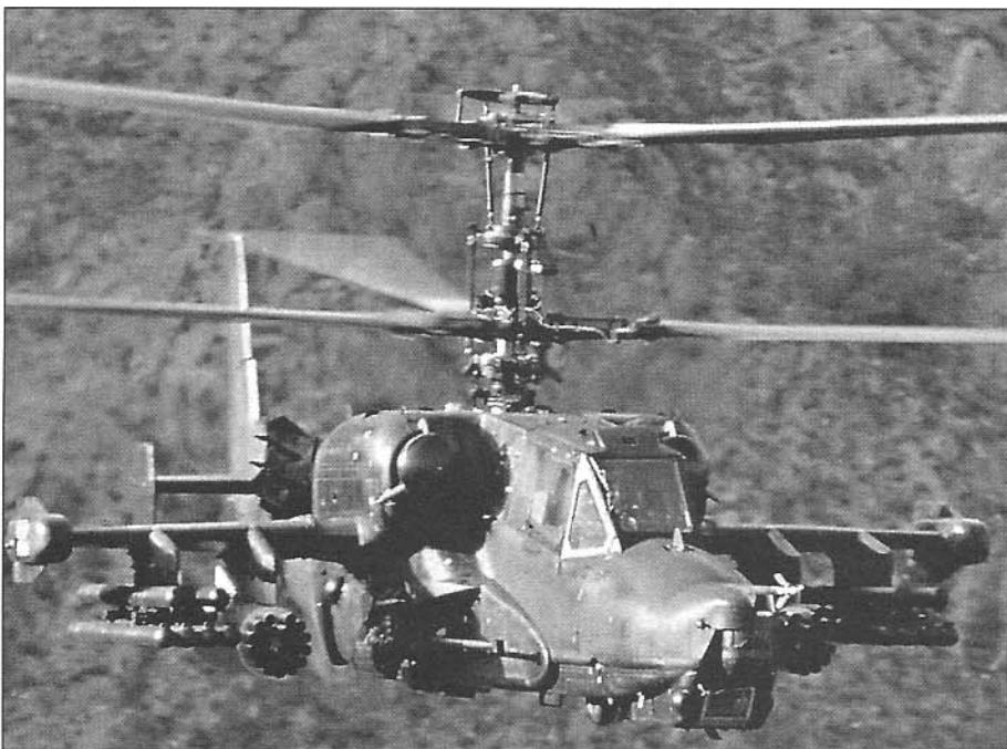
Пятый экземпляр Ка-50 с установленным в носовой части макетом комплекса «Столб» The fifth Ka-50 with «Stolb» complex mock-up mounted in the nose part
