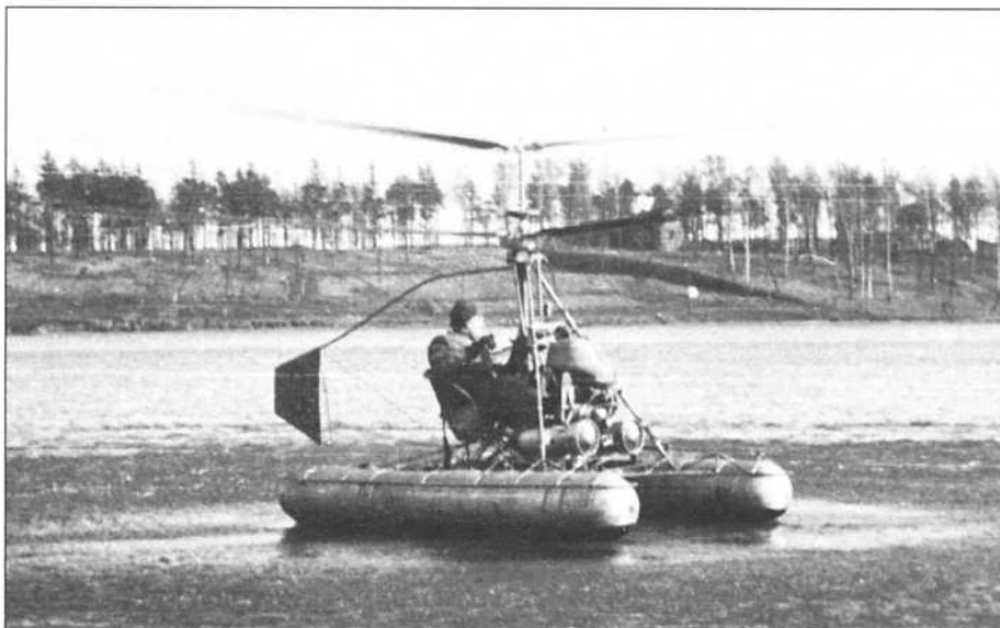
«Мореходные» испытания доработанного Ка-8 «Marine» tests of the developed Ka-8
