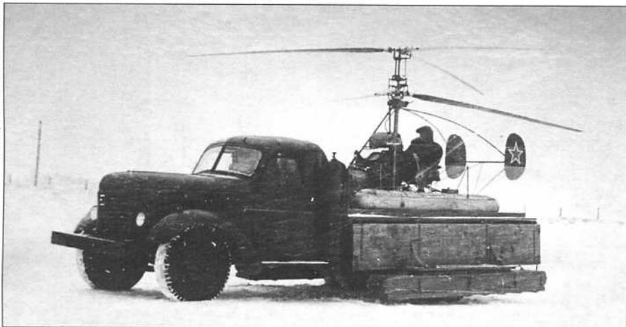
Отработка посадки Ка-10М в кузов грузовика ЗиС-150 на аэродроме Захарково Training operations on Ka-10M landing on the ZiS-150 lorry at Zakharkovo aerodrome
