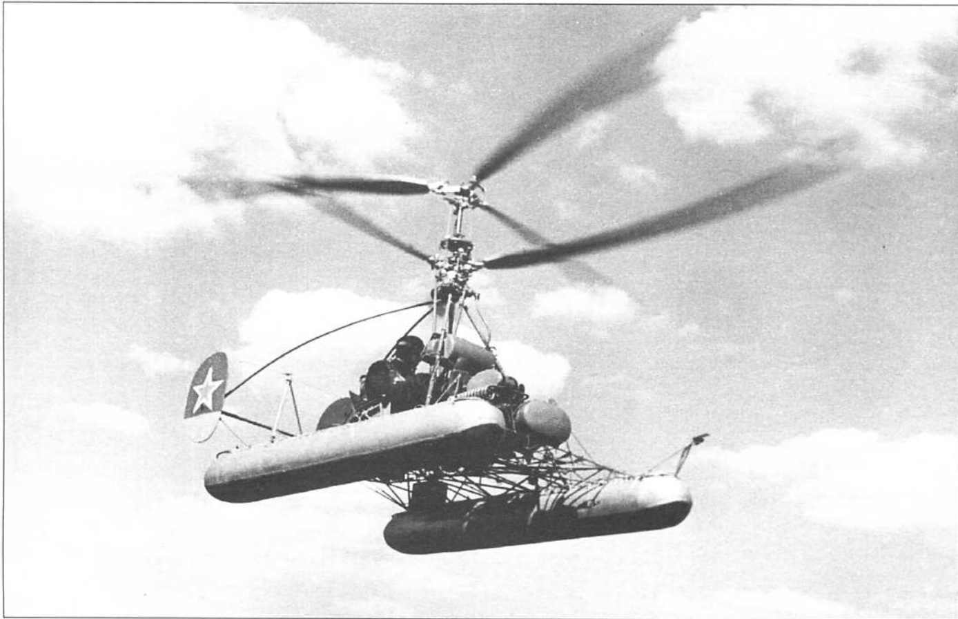
Ка-10М стал первым в мире вертолетом соосной схемы, поступившим на вооружение
