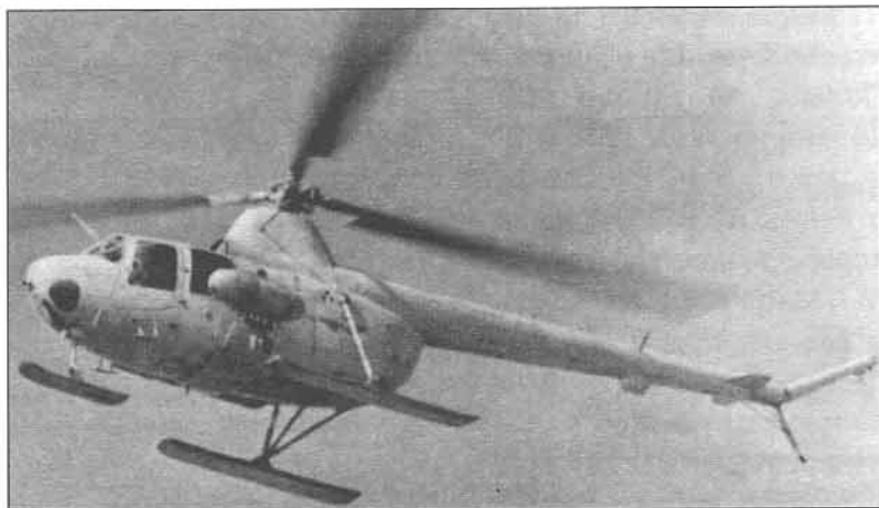
Ми-1НХ на лыжном шасси Mi-1HX helicopter with ski landing gear
