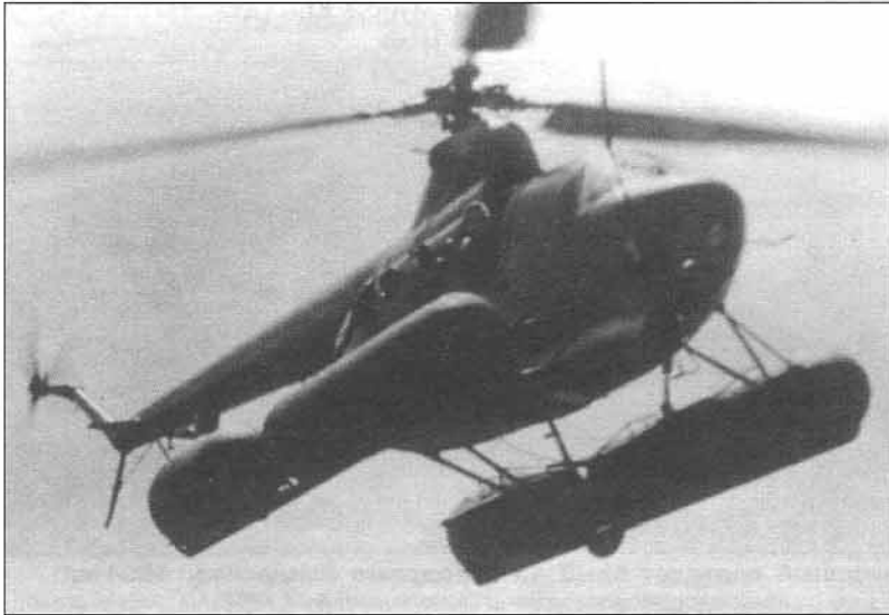
Ми-1МГ с поплавковым шасси Mi-1MG helicopter with float-type gear
