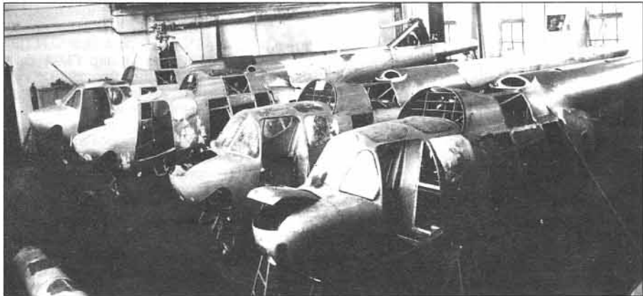
Сборка Ми-1 первой серии на ГАЗ №3 в Москве Mi-1 initial batch assembling at the Moscow State Aircraft Factory №3
