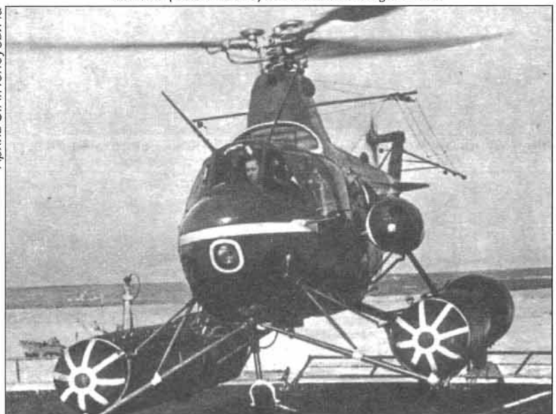
Ми-1МГ взлетает с борта ледокола. Вертолет оснащен дополнительными радиантеннами
