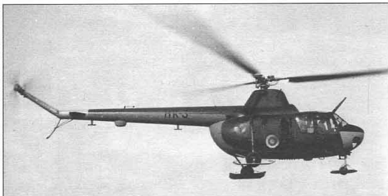
SM-1W ВВС Финляндии с колесно-лыжным шасси, весна 1964 г. SM-1W of Finnish Air Forces with wheel and ski landing gear, spring 1964
