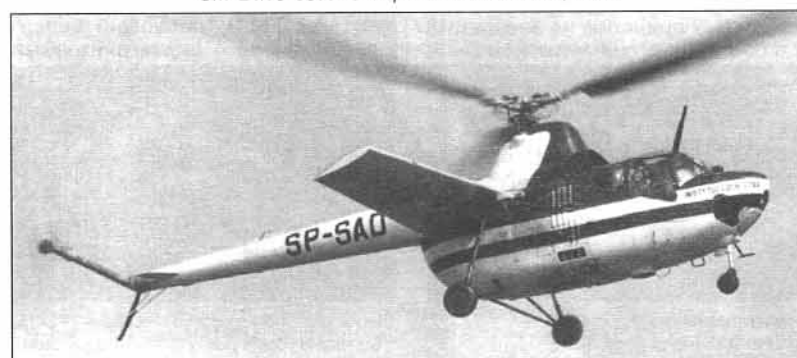
Экспериментальный SM-1/300 с дополнительным крылом, 1971 г. SM-1/300 experimental helicopter with additional wing, 1971
