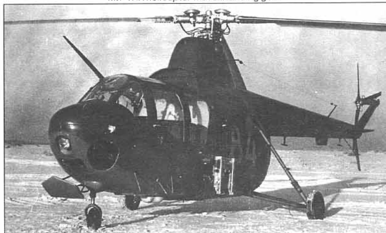
Опытный Ми-1М с аэродинамическим компенсатором, 1959 г. Mi-1M experimental helicopter with additional tab, 1959
