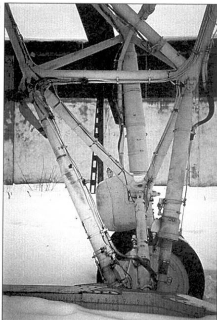
Правая задняя опора шасси и гидрозхват
