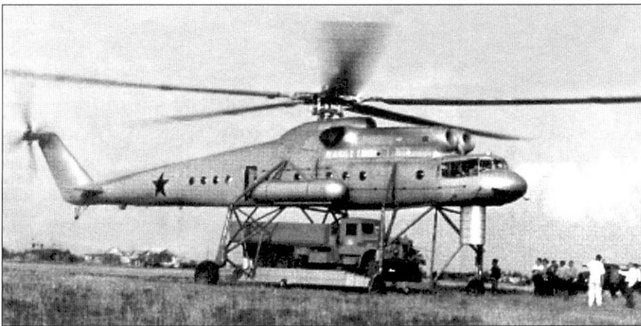
В ходе испытаний первый опытный Ми-10 оснастили нескладывающейся шахтой аварийного покидания
