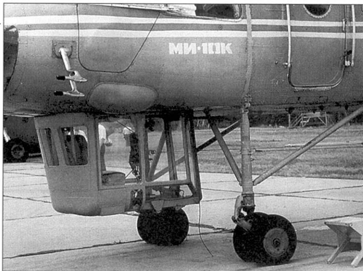
Передние опоры шасси и подвесная кабина серийного Ми-10К Nose landing gear and attached cabin of the Mi-10K
