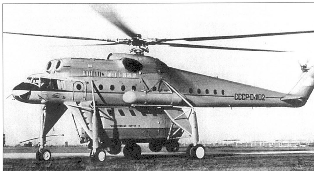
Второй опытный Ми-10, переоборудованный в носитель универсальной полевой лаборатории Ми-10УПЛ
