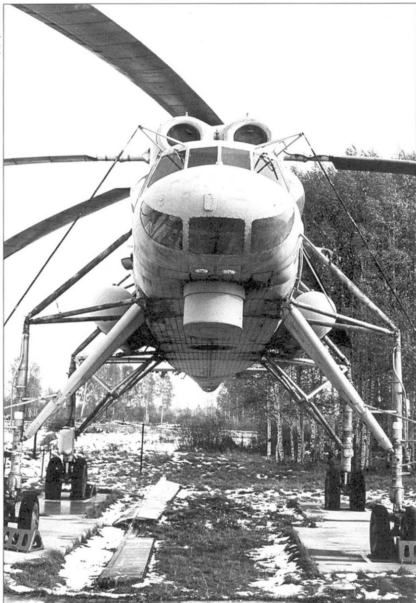
Клиренс шасси Ми-10 составил 3,75 м The Mi-10 landing gear clearance was 3.75 m
