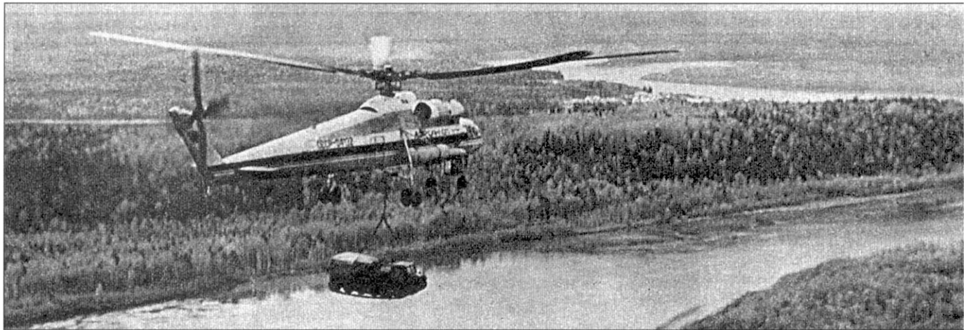
Ми-10К в отдаленных северных и таежных районах использовались не только по своему прямому назначению, но и для доставки крупногабаритных грузов
