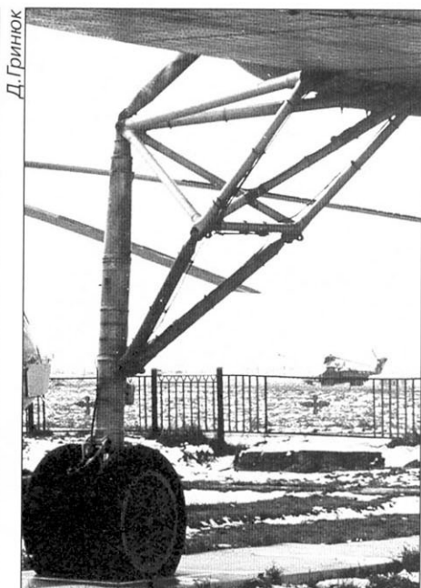
Левая задняя опора шасси. Гидрозхват демонтирован
