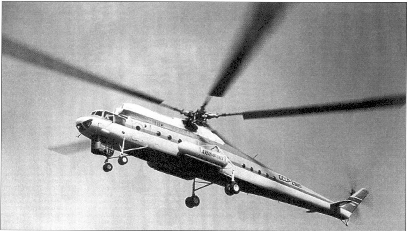
Перед внедрением в серию Ми-10К получил увеличенную подвесную кабину Before start of its serial production, the Mi-10 was equipped with increased attached cabin
