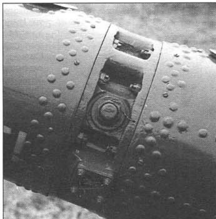
Хвостовая и килевая балки стыкуются через корпус промежуточного редуктора
