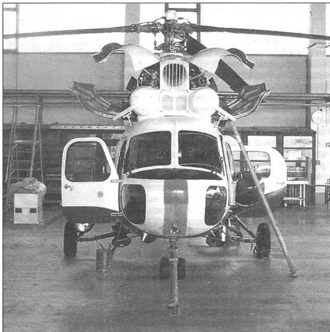
Один из последних Ми-2 полиции ФРГ. На воздухозаборниках двигателей установлены пылефильтры. Берлин, аэродром Шенефилд, май 2003 г.
