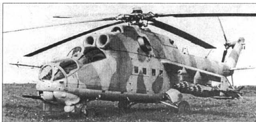
Первый прототип Ми-24Д имел толкающий рулевой винт
