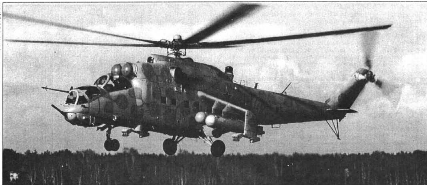
Ми-24Р из 113-й ОВЭ армейской авиации России. Сперенберг, Германия, 5 апреля 1994 г. На пилонах - подвесные топливные баки
