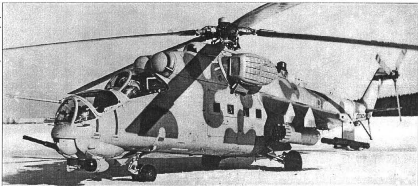
Ми-24В, принимавший участие в боевых действиях в ДРА. На вертолете установлены ПЗУ и ЭВУ
