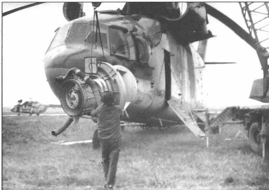
Замена засоренного радиоактивной пылью ПЗУ. Аэродром Малейки Anti-dust device foul with radioactive dust is being replaced. Maleyki airfield
