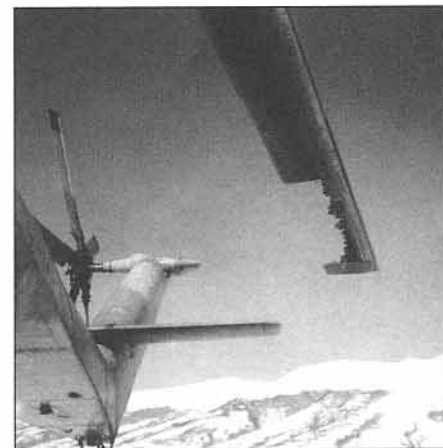
Во время операции по ремонту Ми-26 из 325-го ОТБВП, совершившего вынужденную посадку после прострела лопасти. Чечня, 1999 г.
