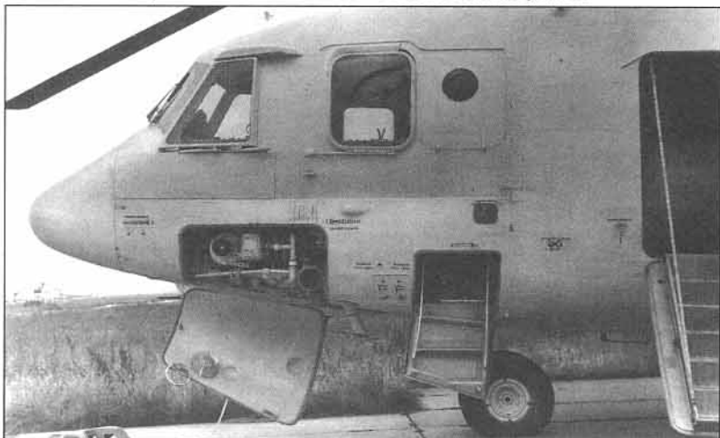
На военных Ми-26 метеорадар «Гроза-М» не устанавливался «Гроза-М» weather radar was not installed at military Ми-26
