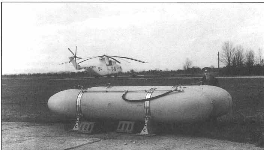
Дополнительные баки Ми-26. На заднем плане - вертолет, работавший в Хорватии. Калинов, апрель 1998 г.
