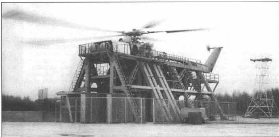
Натурный испытательный стенд силовой установки и несущей системы Ми-26 Full-scale test stand for Mi-26 power plant and carrying system
