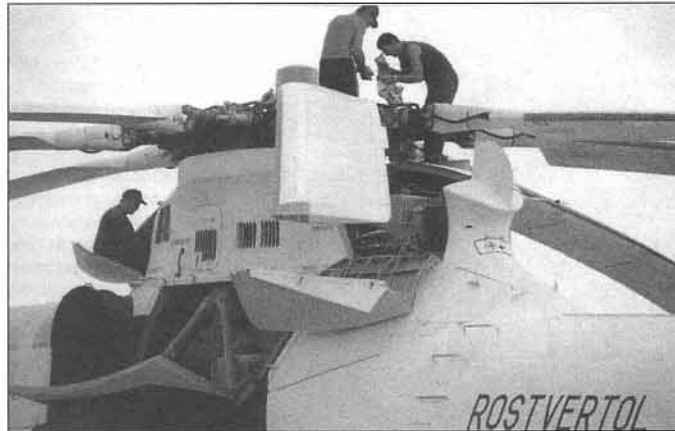
Конструкция капотов Ми-26 позволяет обслуживать с них силовую установку и трансмиссию Mi-26 cowlings design allows to maintenance power plant and transmission from them
