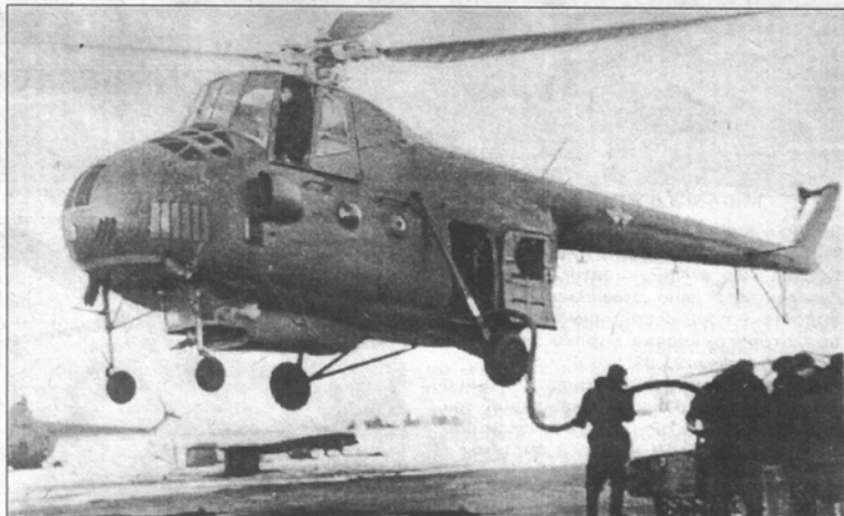
Заправка Ми-4Л огнегасящей жидкостью на режиме висения
