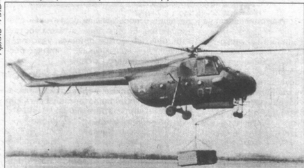
Ми-4А транспортирует груз на внешней подвеске. Бортовой номер 07 - желтый. Южная группа войск, Венгрия
