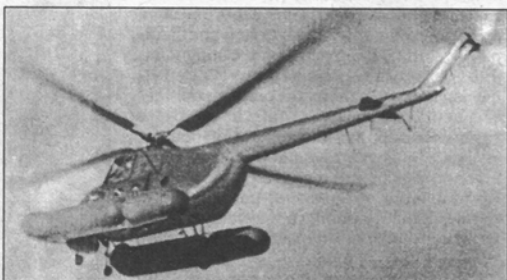
Ми-4ПС с баллонетами на испытаниях
