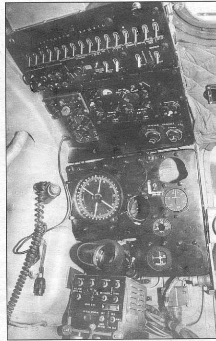
Приборный щиток кабины штурмана Instrumented panel in navigator's cabin
