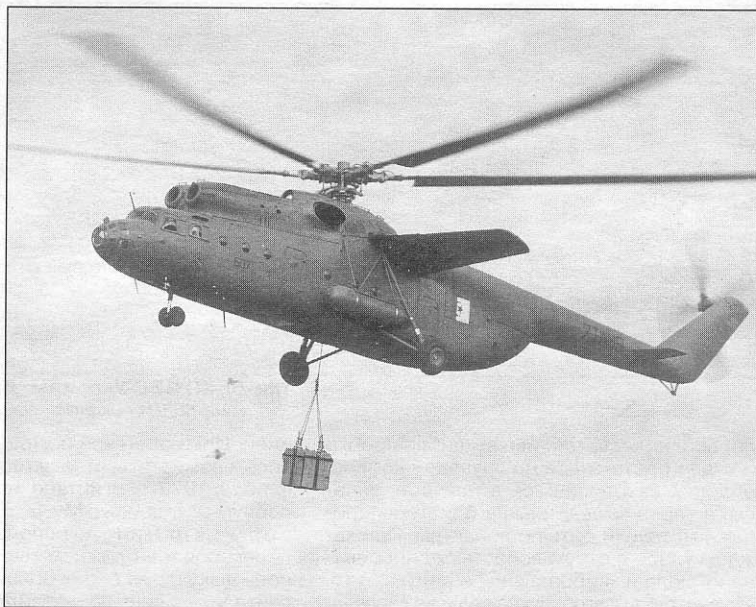
Ми-6А ВВС Алжира транспортирует фундаментный блок автоматического погранпоста
