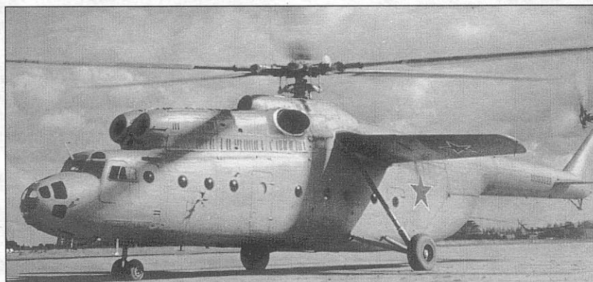
Третий летный экземпляр Ми-6 с двигателями Д-25В The third Mi-6 flying prototype is powered by D-25B engines
