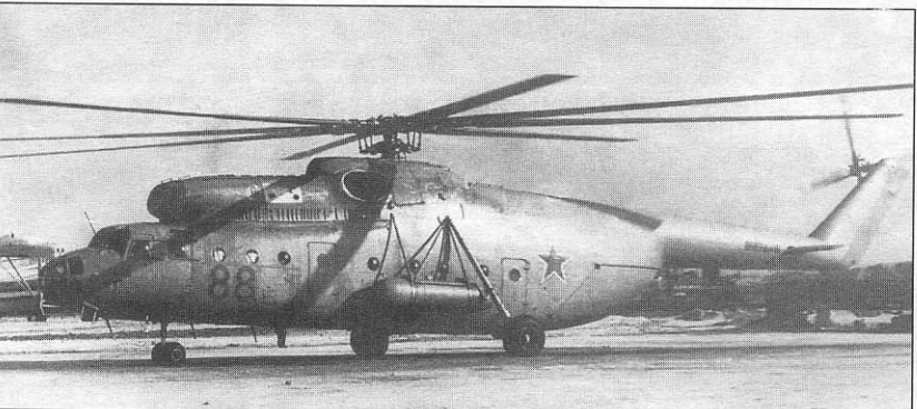
Летающая лаборатория для испытания несущего винта Ми-26 Flying laboratory for Mi-26 main rotor test
