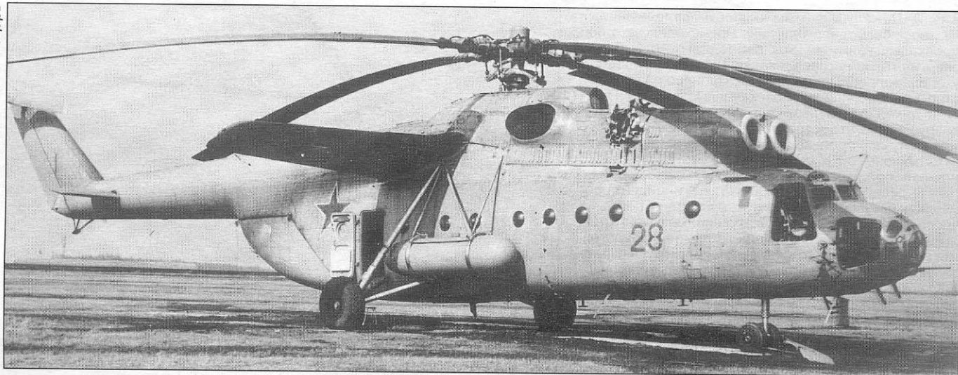
Ми-6 51-го ОГВП после вырыва свободной турбины одного из Д-25В. Апрель 1974 г. Mi-6 of the 51st ОГВП after Д-25В free turbine explosion. April 1974
