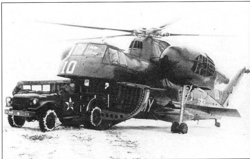
Армейский джип мог своим ходом въехать по аппарели в носовой грузовой люк СН-37.
