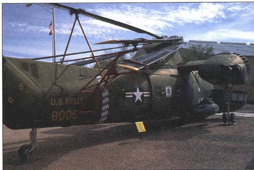
На этом снимке хорошо видна стойка хвостового колеса и система кронштейнов для крепления лопасти несущего винта в сложенном положении.
