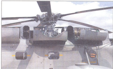
Интерьер грузопассажирской кабины, раскапотированная силовая установка и втулка несущего ротора.
