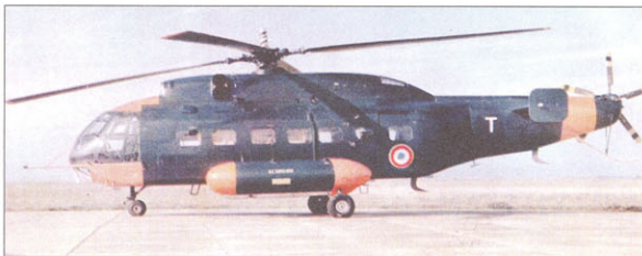
Второй прототип «Фрелона» с удлиненной хвостовой балкой.
