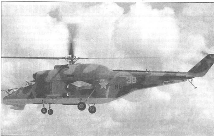
Имитатор вертолета Ми-24, построенный фирмой «Орландо Геликоптер» на базе вертолета «Сикорский» Н-19.
