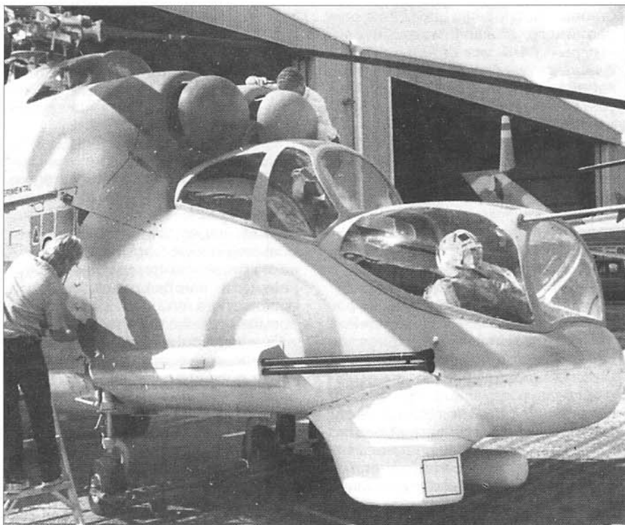
Макет носовой части Ми-24П, установленный на вертолете «Сикорский» Н-19. Хорошо видны манекены пилотов.
