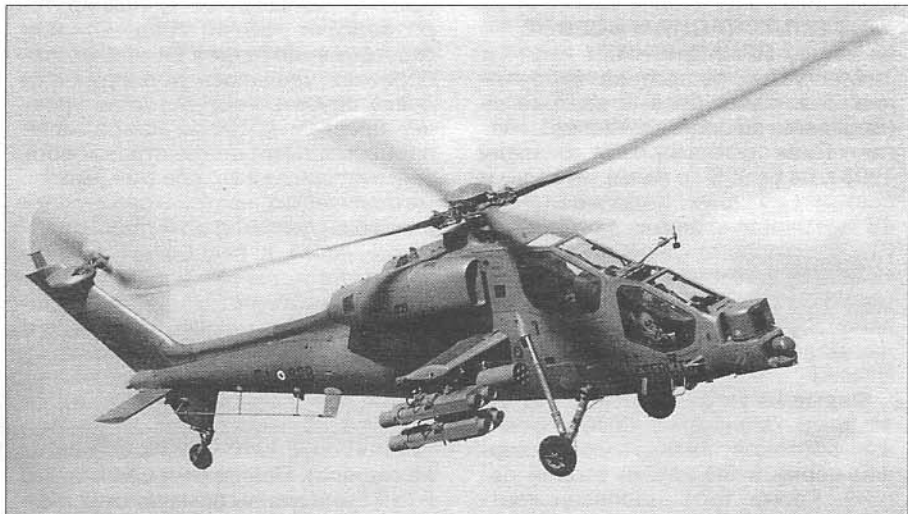
Серийная «Мангуста» первой модификации с полным комплектом подвешного вооружения.
